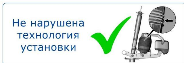
Для правильной установки заднего пневмобаллона Mercedes E-class w211, Mercedes CLS-class w219 используйте специализированный инструмент под номером E4-ХК0-Z024A00.
